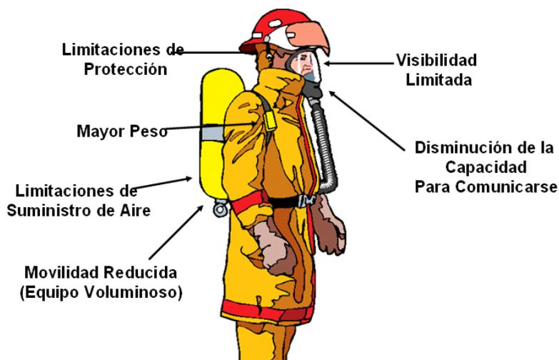
Existen dos clases de Air Pack y se clasifican como de circuito abierto y de circuito cerrado.
