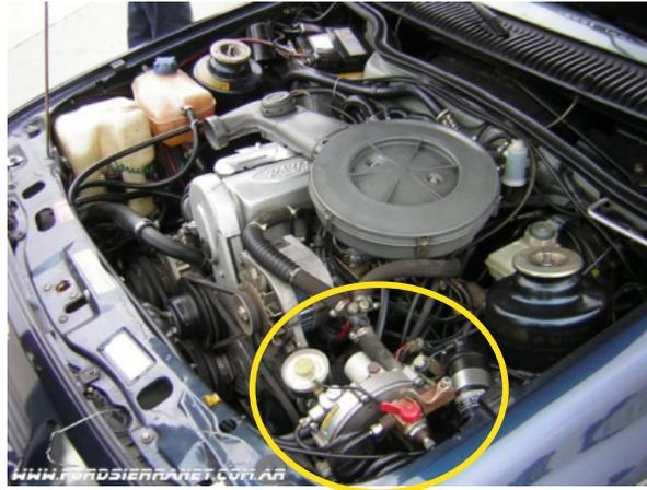
Siempre que sea posible se cerrara la válvula del tubo de GNC esto evitara la salida del gas (Foto 9).-
