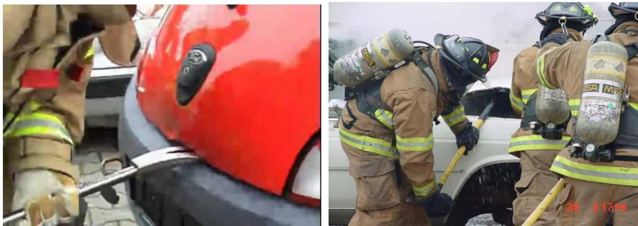
Otra forma es utilizando una herramienta formada por un hierro circular que en uno de sus extremos tiene una canaleta y en su otro extremo una palanca de sujeción, el método consiste en introducir la herramienta entre el capot y la parrilla tratando de introducir el cable de apertura del capot y una vez introducido el mismo se hará girar hasta que se accione el sistema.-
