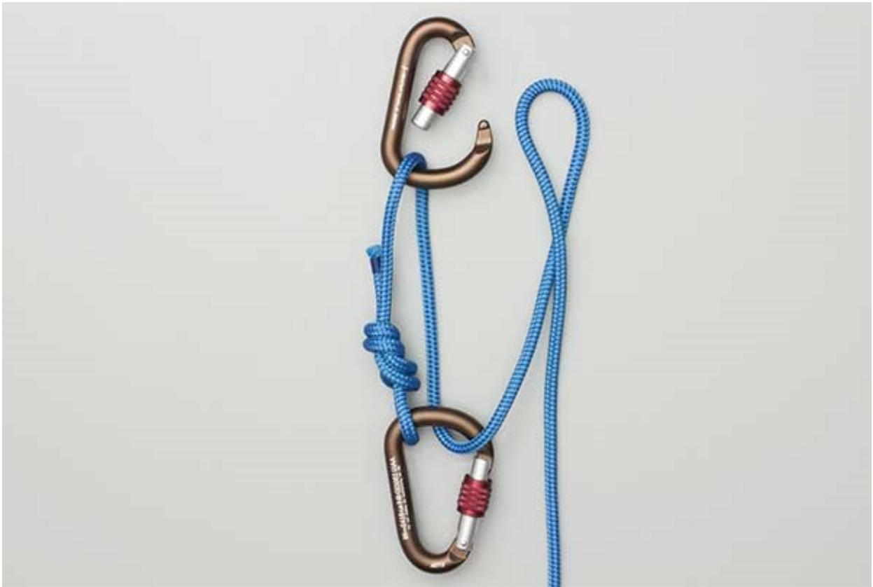
Forma simplificada de comenzar un Radian Release Hitch. Este anclaje de extensión ocupa treinta pies de cordino de 8 mm y dos mosquetones en forma de pera.
