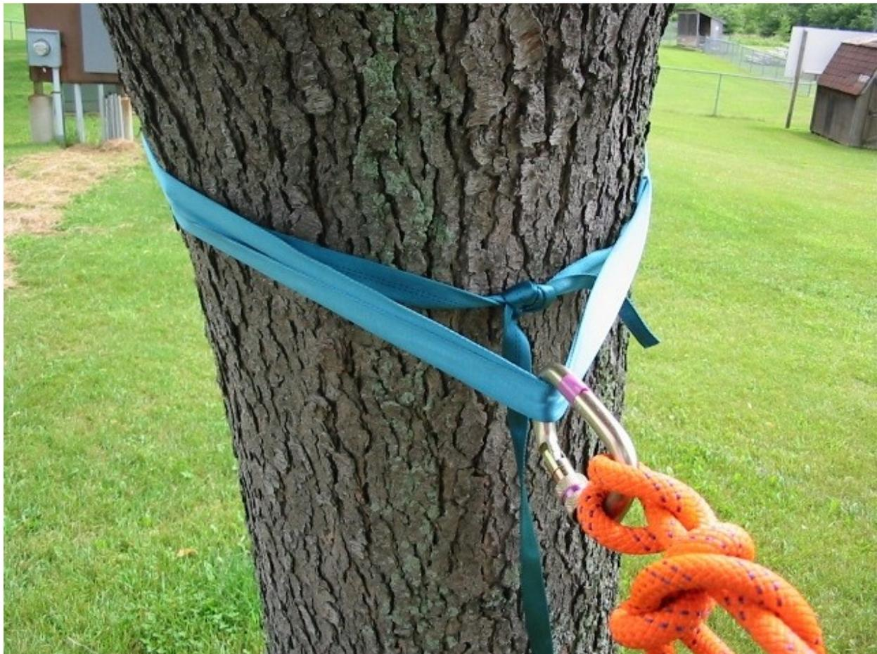
**Anclaje de carga compartida.** Siempre que sea posible los anclajes para rescate en ríos deben ser dinámicos, esto es, que tengan la capacidad de mover la carga y sostenerla en distintos ángulos sin exceder los 120 grados.
