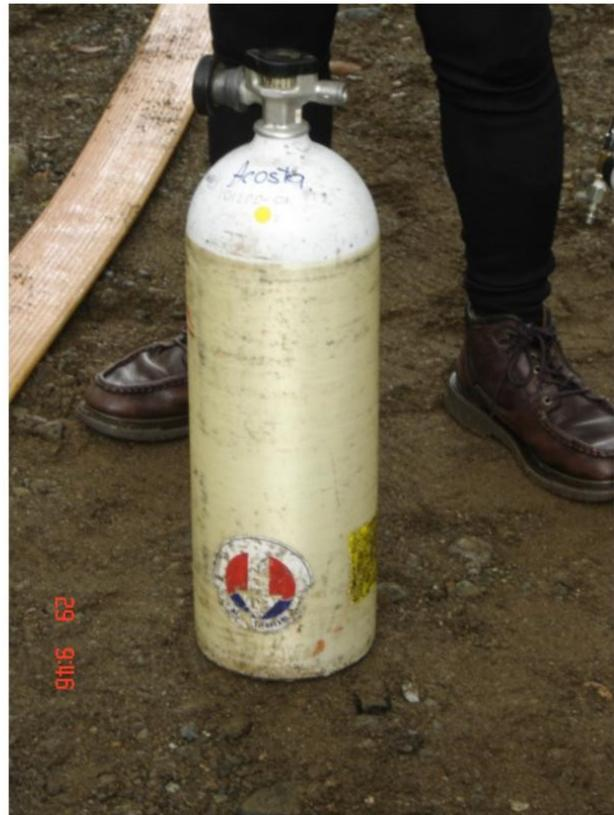
Dispositivo para inflar mangueras de bomberos. Asegúrese que la cubierta tiene una junta nueva y que el cilindro tiene la inspección y aprobación adecuada. Sergio Flores Izaguirre©
